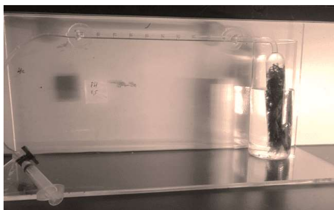
Gambar 2. Kit alat praktikum Fotosintesis Ingenhousz
